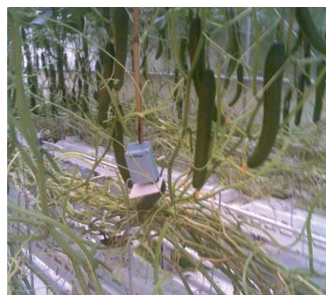
Figuur 1. Een tijdelijke sensor voor temperatuur en vochtigheid in een komkommerkas.
