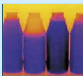
Figuur 2. Zijn de flessen ondoorzichtig voor gewoon licht, dan nog kan met infrarood een goed beeld verkregen worden of ze geheel gevuld zijn (mits de vloeistof warmer is dan de omgeving).
