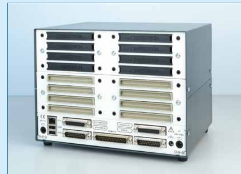
Figuur 4. De achterkant van de WK 260 PC toont dat het om een modulair apparaat gaat.
