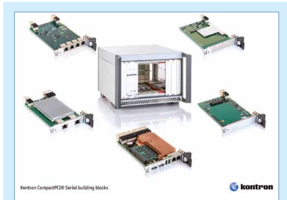
Figuur 3: Vijf vliegen in één klap! Met een processorkaart, twee netwerkcontrollers, een XMC-draagkaart en een SATA-draagkaart voor harde schijven biedt Kontron meteen al de meest belangrijke componenten voor CompactPCI Serial. Deze worden eveneens volledig vooraf geïntegreerd in systeemconfiguraties aangeboden.
