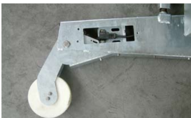
Figuur 2. Ondanks dat de sensor netjes in de schuifarm ingebouwd is, is het prettig dat het gaat om een exemplaar met beschermingsklasse IP67.
