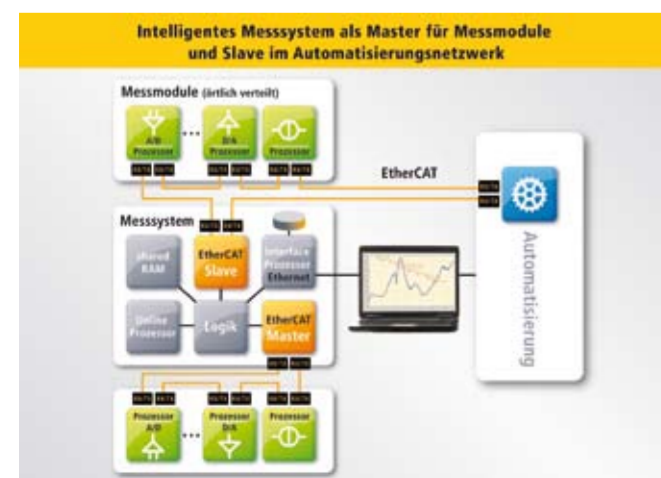
Figuur 1. Het intelligente meetsysteem Cronos vormt hier de brug tussen twee aparte EtherCAT-netwerken.
