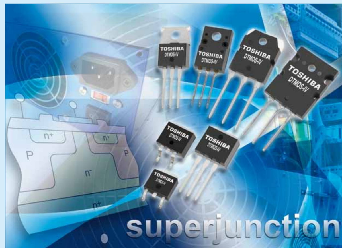
Figuur 2. De nieuwe MOSFET's van Toshiba hebben een zeer lage R_{DSon} en zijn daardoor zeer geschikt voor diverse applicaties binnen het bereik van 600 V.
