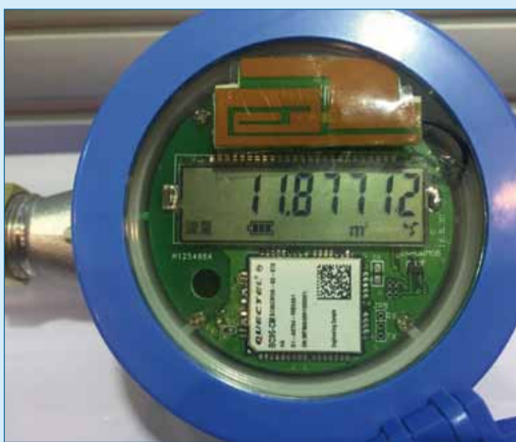
Afbeelding 1. In deze watermeter is een NB-IoT-module van Quectel verwerkt.
