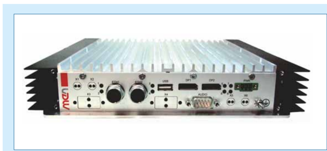
Afbeelding 2: Tegen de vlakke zijkanten van de behuizing kunnen extra koelvinnen worden aangebracht.
