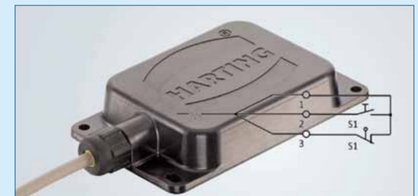
Figuur 5. RFID met leesmogelijkheid voor schakelcontacten biedt diverse nieuwe mogelijkheden.
