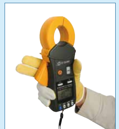
Figuur 5. De nieuwe lichtgewicht meettang voor metingen aan meer- voudig gearde netten.
