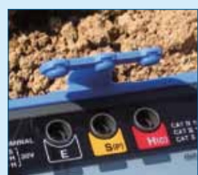
Figuur 3. De hoge bescher- mingsgraad wordt alleen gehaald als de aansluit- terminals zijn afgesloten.
