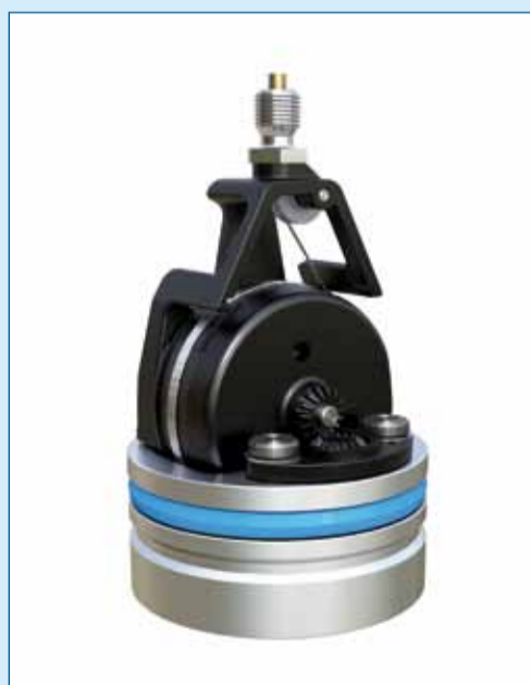
Figuur 1. De SGH10 bestaat uit een basisplaat die tevens als afdichting dient met daarop aan de ene kant een trekdraadsensor en aan de andere kant de elektronica.
