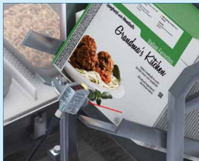
Figuur 5. Tellen van kartonnenverpakkingen kan met de sensor met analoge uitgang.
