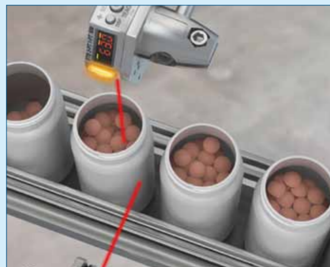
Figuur 6. Door het uitvoeren van een serie metingen kan de sensor het gemiddelde hoogteniveau van de pillen in de verpakking bepalen.
