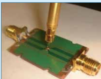
Figuur 1. Speciale coaxiale testprobes van INGUN Prüfmittelbau zijn noodzakelijk voor het testen van HF-schakelingen.
