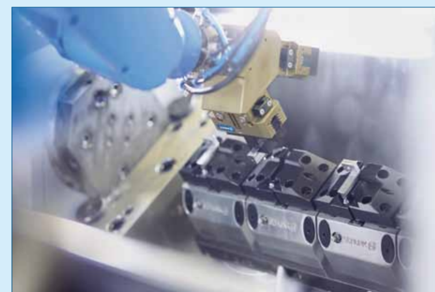
Afbeelding 3. Met behulp van het nulpuntpansysteem SCHUNK VERO-S kunnen SCHUNK TANDEM plus krachtpanblokken met enkele handelingen in de kortst mogelijke tijd volledig uit de machine worden verwijderd.
