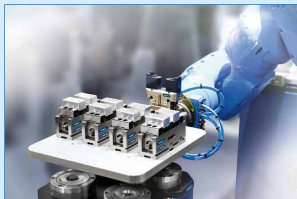
Afbeelding 2. Palletsystemen verhogen de productiviteit en het rendement bij kleine en middelgrote aantallen.
