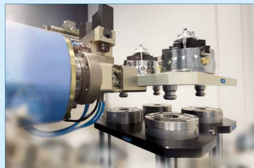
Afbeelding 1. Met de SCHUNK VERO-S NSR robotkoppeling worden spanpallets veilig verwerkt. Op de machinetafel garandeert het SCHUNK-nulpuntpansysteem een goede grip en een maximale herhaalnauwkeurigheid.
