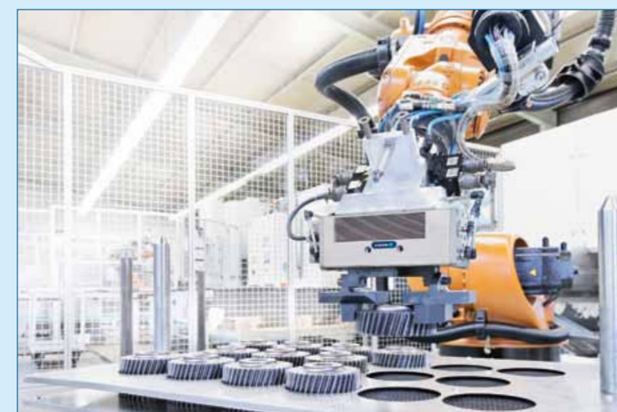
Afbeelding 5. Mechatronische grootslaggrijpers zoals de SCHUNK PEH 40 maken dankzij hun variabele slag een flexibele handling van uiteenlopende onderdelen mogelijk.
