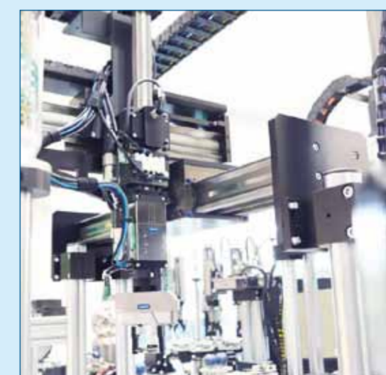
Afbeelding 6. Lineaire motoren kunnen ingezet worden voor het transport van pallets, gereedschappen, maar kunnen ook in de machine zelf ingezet worden om frees- of boorkoppen te verplaatsen.
