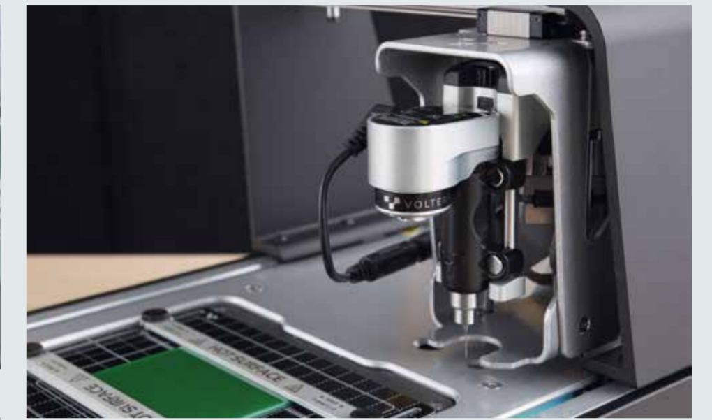
Afbeelding 2. Moeten er gaten in de print komen, dan kan daarvoor een boormachine op de printer gemonteerd worden.
