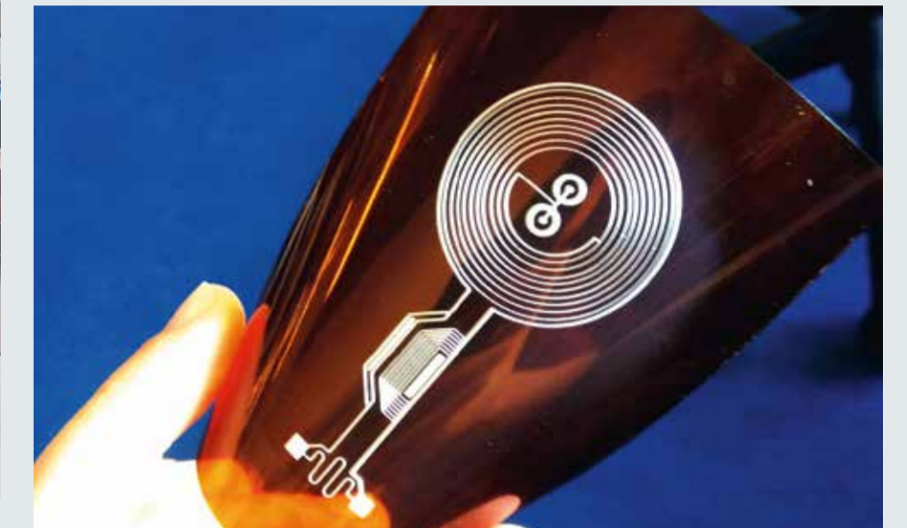
Afbeelding 4. Met de onlangs ontwikkelde buigbare inkt zijn flexibele printen te maken.
