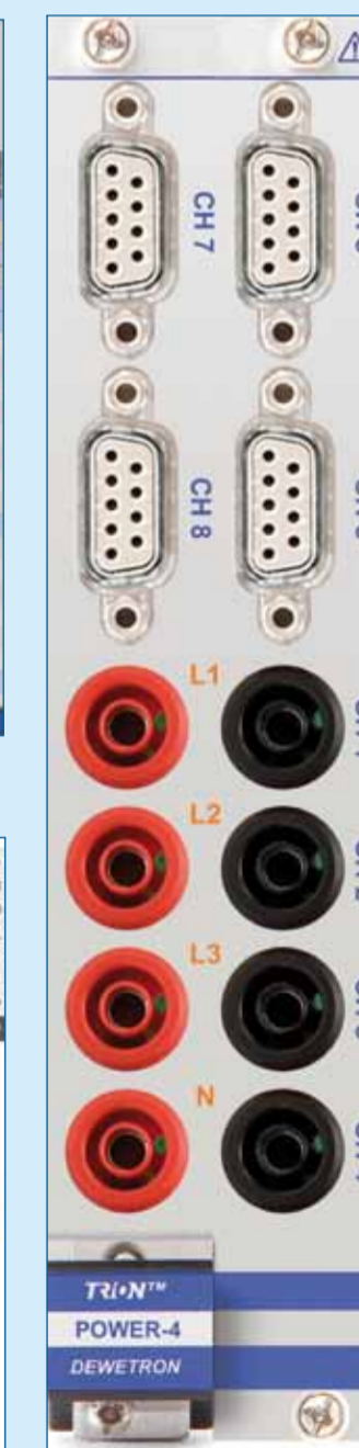
Afbeelding 6. Deze meetkaart is een achtkanaals power analyzer.
