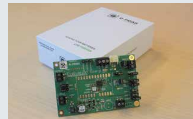
Afbeelding 4. In het midden treft u de AEM20940 aan en de onderdelen die extern noodzakelijk zijn.
