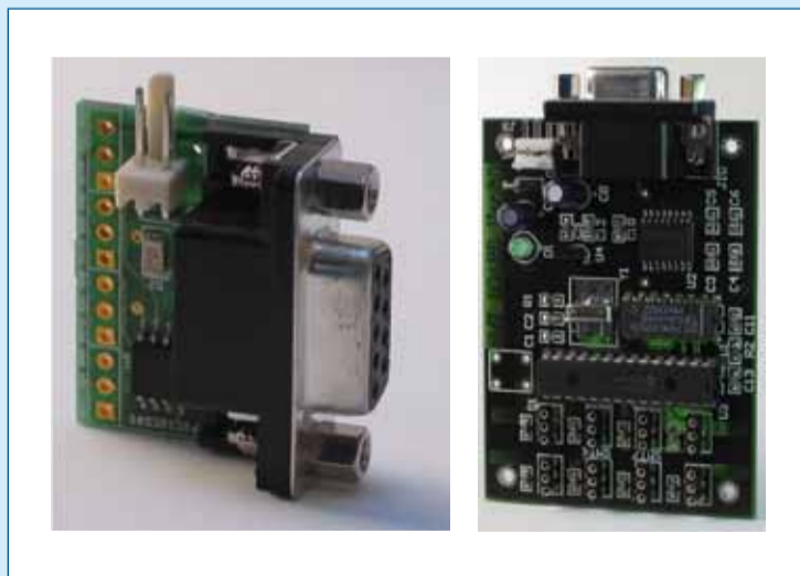
Figuur 2. De twee demo-printen (A de print voor vier sensoren en B het exemplaar voor 8 sensoren).
