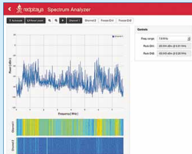
Figuur 3. Een spectrum gemeten met de Red Pitaya.
