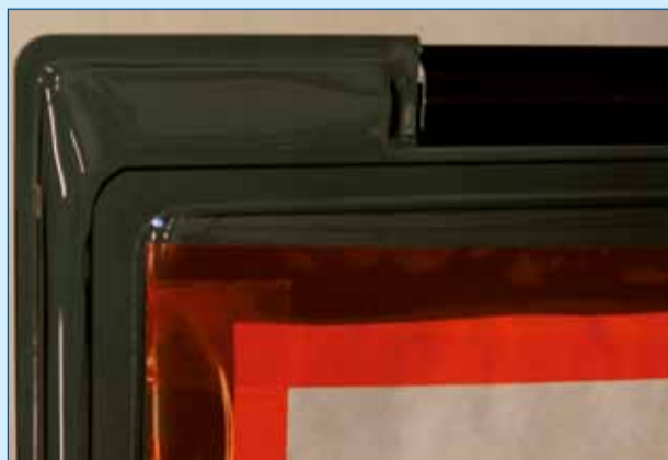
Figuur 1. De pers mag het kunststof niet kapot persen.
