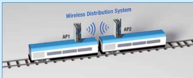
Figuur 1. Voor de verbinding moeten de MAC-adressen van AP1 en AP2 handmatig ingesteld worden.
