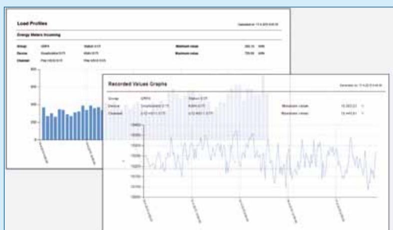
Afbeelding 1. Smartcollect PM10 vormt altijd de basis en is in staat om meetinstrumenten (kWh-meters, powermeters etc.) via diverse interfaces uit te lezen. Hierbij werkt de software merkonafhankelijk.
