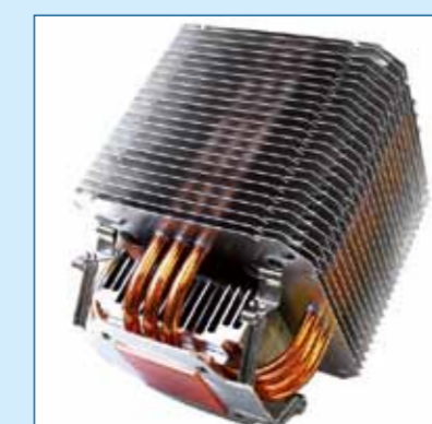
Figuur 4. De heat pipe inclusief de koelelementen worden veelal als een totale thermische assembly op maat geproduceerd.
