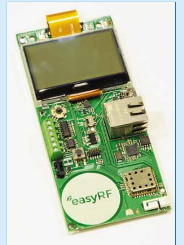
Figuur 5. De print van de evaluatiekit waarop naast de IRF1000 ook de nodige sensoren en een display te vinden zijn.
