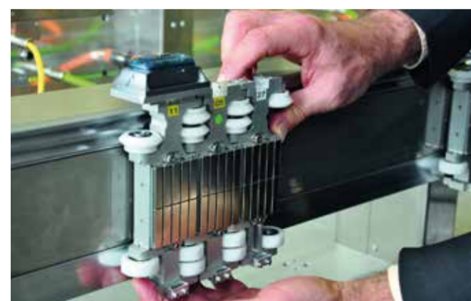
Afbeelding 2. De shuttle en de track werken als lineaire motor.
