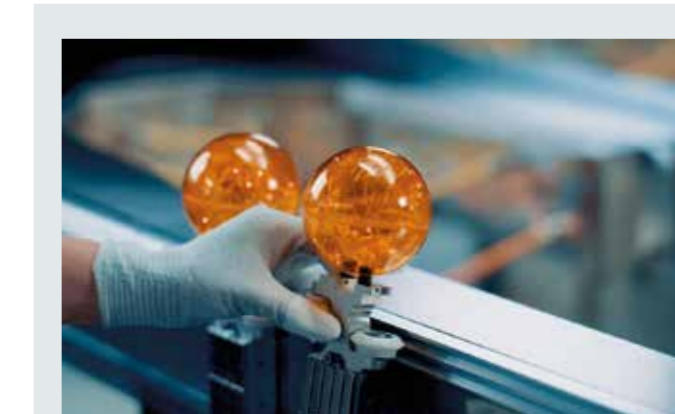
Afbeelding 3. Shuttles kunnen probleemloos toegevoegd of weggehaald worden zonder dat de toepassingssoftware hoeft te worden gewijzigd.
