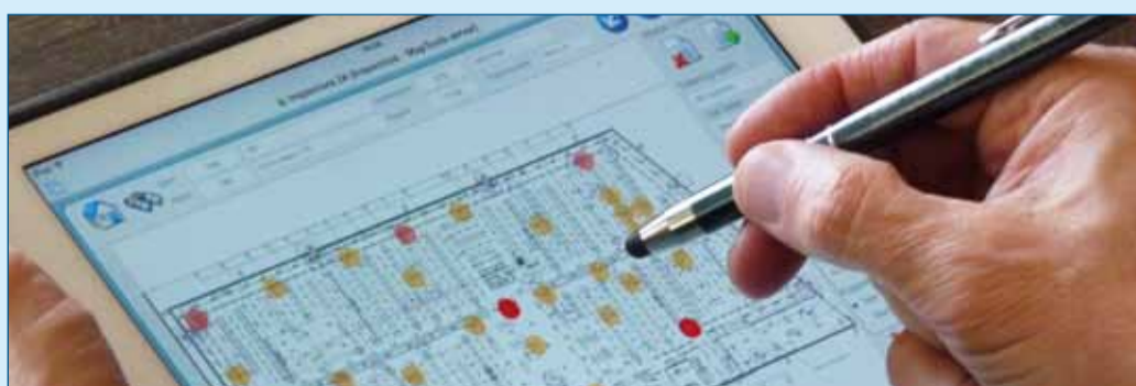
Figuur 1. Zelfgemaakte iconen op de tekening helpen bij het uitvoeren van de inspectie en worden gebruikt om aan te geven wat al wel en wat nog niet geïnspecteerd is en of het geïnspecteerde goed of fout is.
