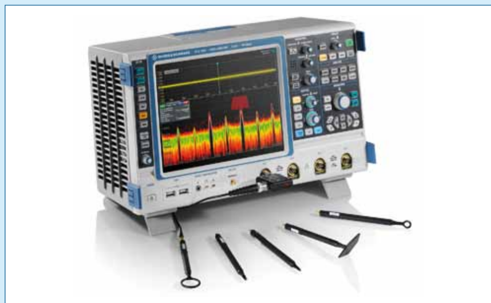
Figuur 3. Ook de oscilloscopen uit de RTO-serie van Rohde & Schwarz maken gebruik van de slimme FFT-technologie waardoor snel en nauwkeurig het frequentiespectrum is te bekijken.
