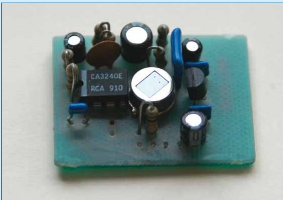
Figuur 1. De lange draden aan de componenten, de daardoor langere printsporen en de hoge versterking zorgen er voor dat deze detector voor passief infrarood zeer gevoelig is voor EMS.
