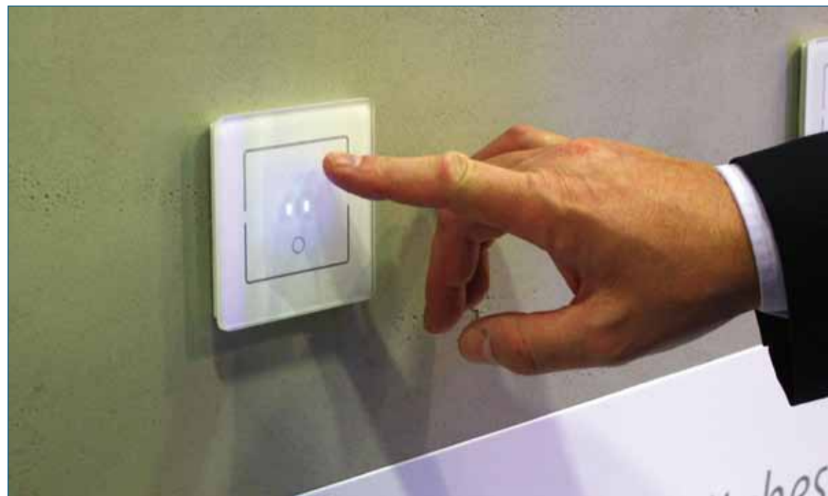
Figuur 2. De blauwe LED-schakelaarverlichting kan altijd aan zijn, alleen bij schakelen even oplichten of als controle-verlichting werken.
