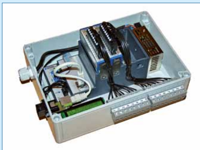
Figuur 2. Om pieken in het stroomverbruik op te vangen, kunnen energieleveranciers noodstroomaggregaten op afstand starten via deze CompactRIO controllers. (Foto VI Technologies)
