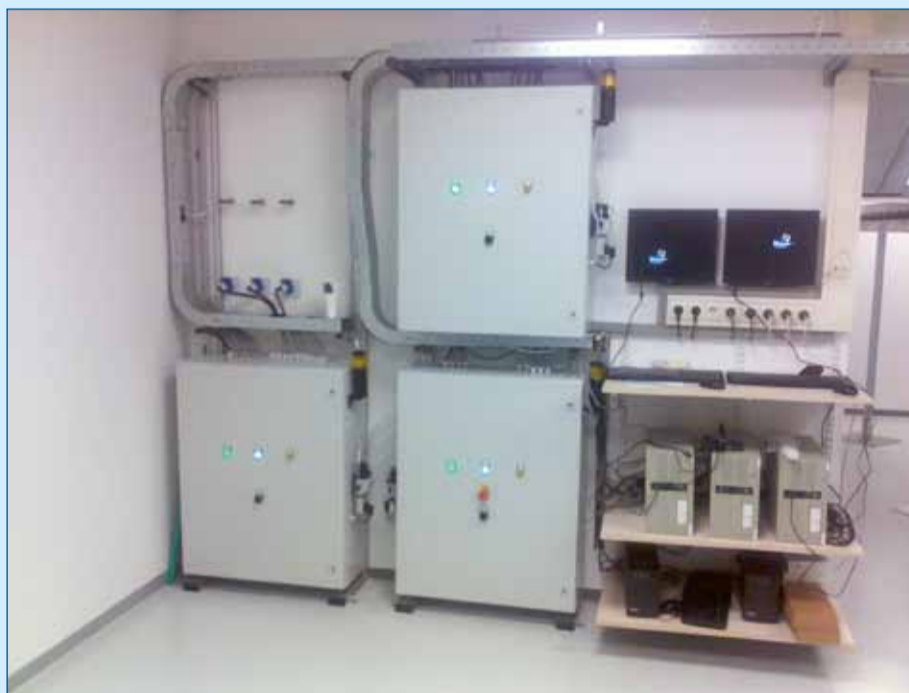
Figuur 5. De besturingskasten samen met drie industriële PC's van HPS.
