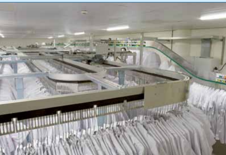
Figuur 1. De KUA van LCT is een geautomatiseerd kledinguitdeelsysteem met vele voordelen.
