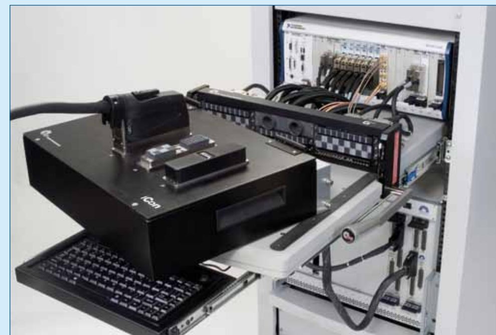
Figuur 3. Een Mass Interconnect Interface verbindt de meetelektronica met de fixture.
