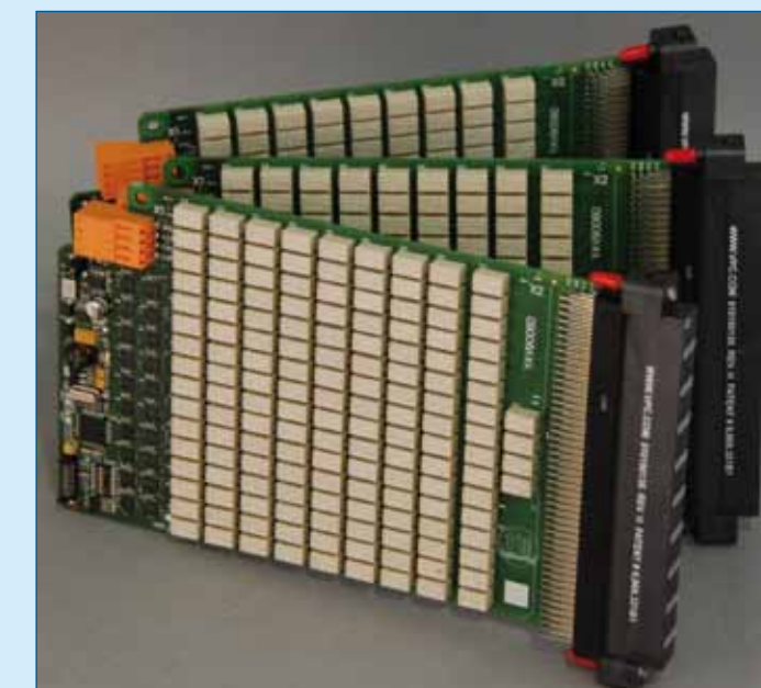
Figuur 4. Op deze YAVModule is de Mass Interconnect module al geïntegreerd.
