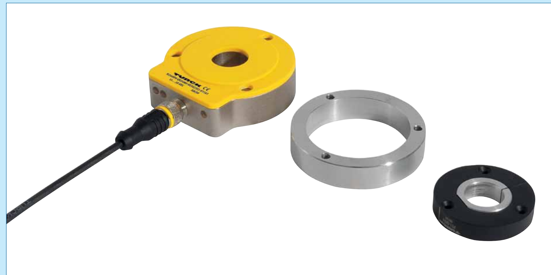
Figuur 1. De encoder bestaat uit drie delen, namelijk de behuizing voor de elektronica, de spoel die op de as gemonteerd wordt en een beschermring.
