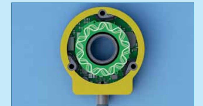
Figuur 4. Het inwendige van de sensor.
