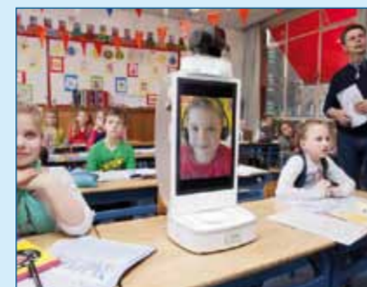
Figuur 3. KlasseContact, ontwikkeld door Intemo voor KPN is een toepassing waarmee een ernstig zieke leerling virtueel in de klas aanwezig kan zijn.
