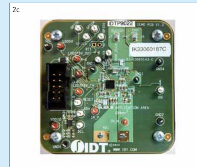
Figuur 2. De zender kan met één (2a) of meerdere spoelen (2b) uitgerust zijn om zo de overdracht naar de ontvanger (2c) te optimaliseren.
