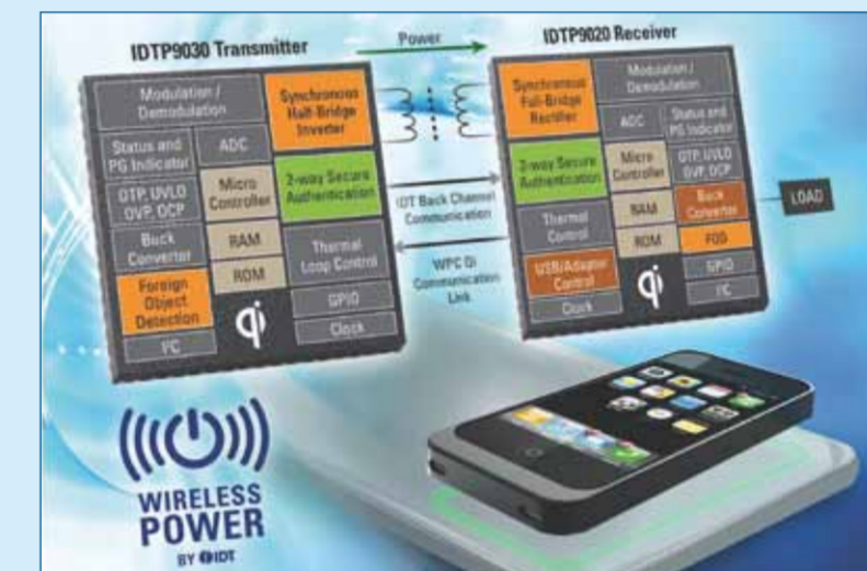
Figuur 3. Het blokschema laat zien dat er heel veel functionaliteit in de IC's van IDT verwerkt zijn.
