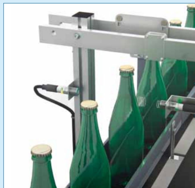
Figuur 2. Ook voor het tellen van bijvoorbeeld flessen op een lopende band kunnen ultrasone sensoren gebruikt worden.
