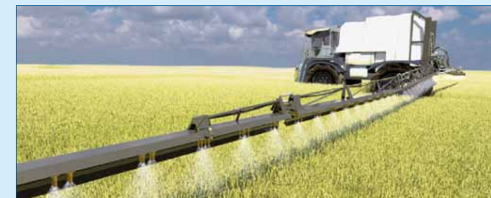
Figuur 5. Ultrasone sensoren worden gebruikt om de hoogte van de sproeiarmen te controleren.
