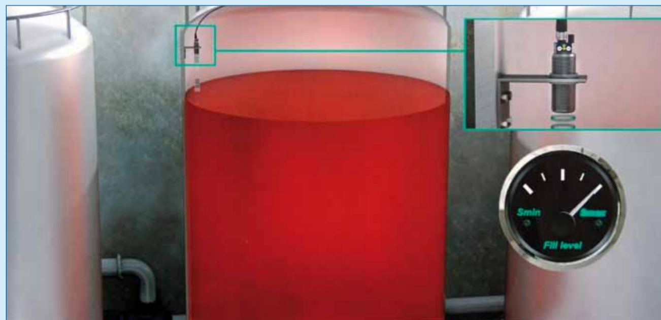
Figuur 1. Voor het meten van de inhoud van een tank of silo is een ultrasone sensor een goede kandidaat.
