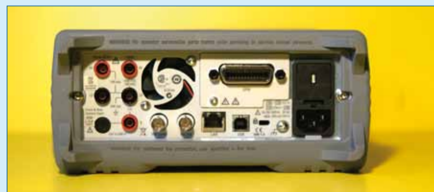
Figuur 5. Op de achterkant vinden we niet alleen dezelfde aansluitingen voor de meetsignalen, maar o.a. ook een LAN-poort, een USB-poort, een optionele GPIB-poort en een triggeringang.
