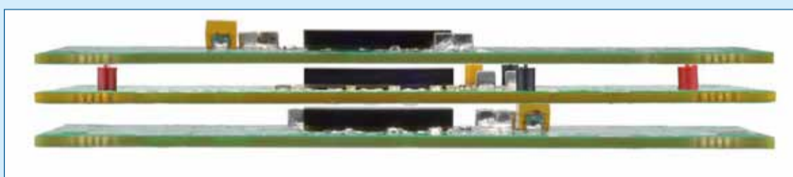
Figuur 1. Door de geringe afmetingen van de module kunnen printen heel dicht bij elkaar gemonteerd worden.
