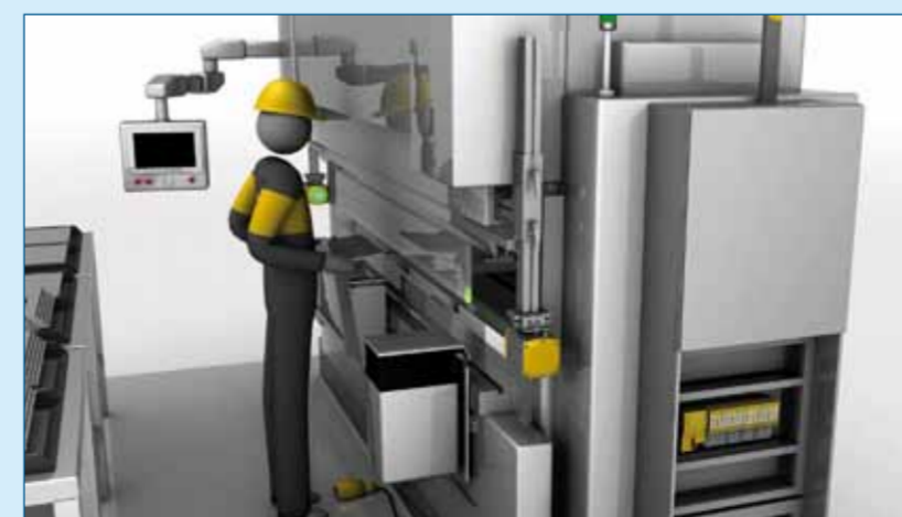
Figuur 6. Lichtbron en camera worden op het bewegende deel van de pers gemonteerd.
