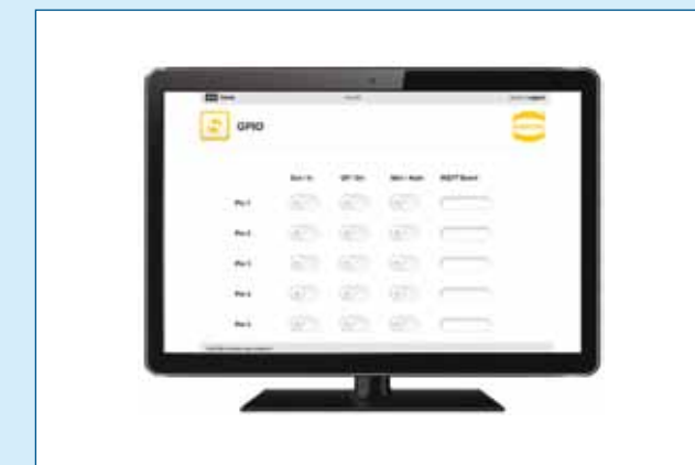
Afbeelding 5. Met het containerprogramma GPOL zijn de I/O-aansluitingen te configureren en uit te lezen of aan te sturen.
