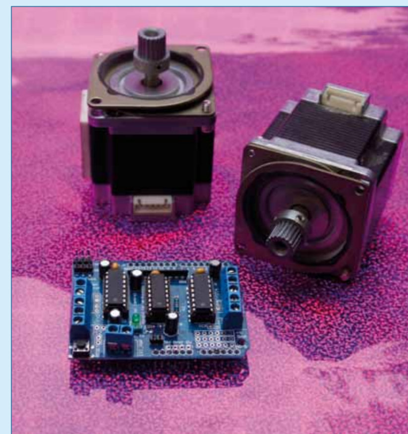
Figuur 3. Met de speciale motor-shield kunnen zowel stappenmotoren als DC-motoren aangestuurd worden.
