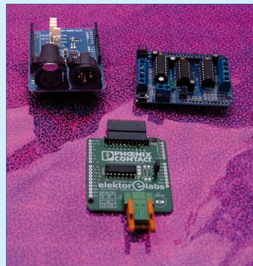
Figuur 1. Op een Arduino kunnen insteekprinten (shields) aangesloten worden voor het verkrijgen van verschillende functies.
