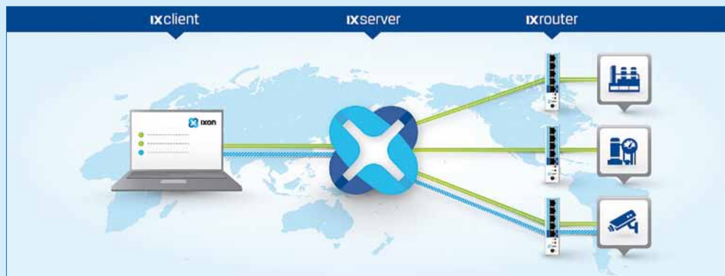
Figuur 1. Om stunnel te kunnen toepassen, moet de server en de router zijn voorzien van de software voor deze coderingsmethode.
