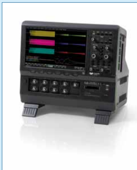
Figuur 2. De HDO8000 heeft 8 analoge ingangen en is daarmee zeer geschikt voor metingen aan driefasesystemen.
