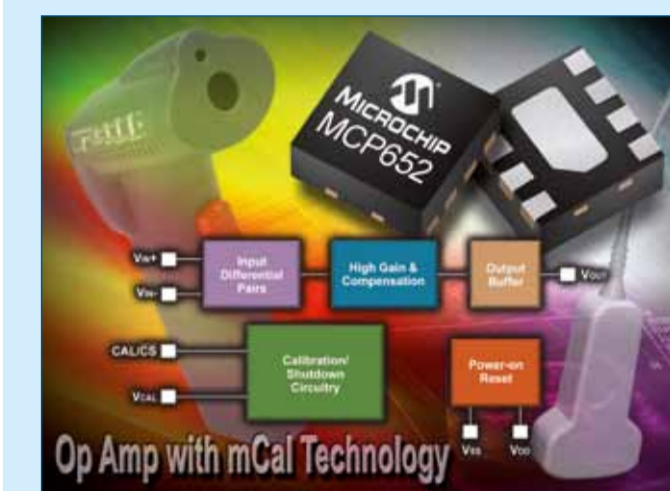
Afbeelding 2: De MCP652 OpAmp met kalibratiepen.
