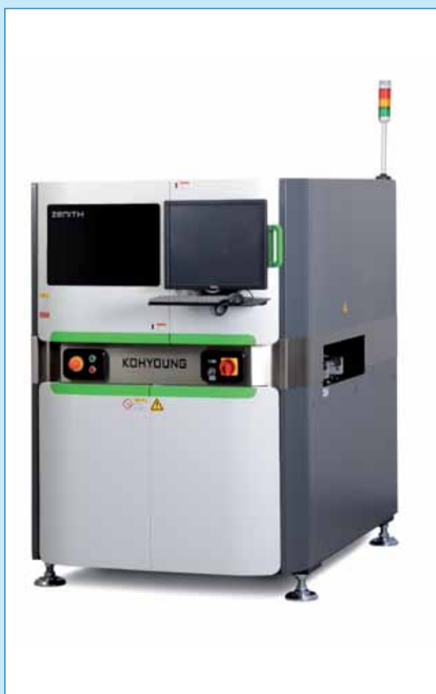
Figuur 1. Koh Young heeft een meetsysteem ontwikkeld die ook hoogteverschillen op een print automatisch zichtbaar kan maken voor een vision systeem.
