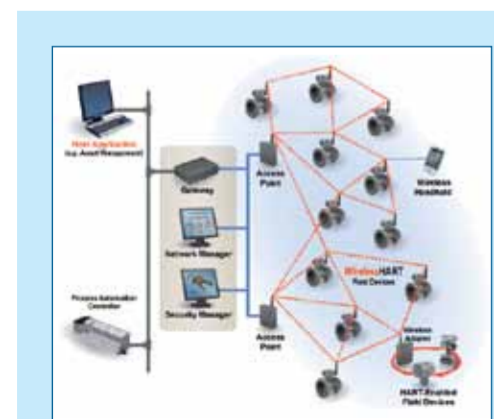
Afbeelding 2: Wireless HART biedt dankzij zijn maasvormige structuur automatisch redundante communicatiepaden.
