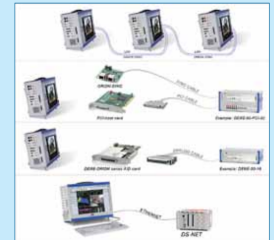
Figuur 4. Timing speelt een belangrijke rol bij snelle uitgebreide meetsystemen. Om er voor te zorgen dat alle componenten binnen een meetsysteem gebruik maken van dezelfde klok, zijn er verschillende opties voor handen.
