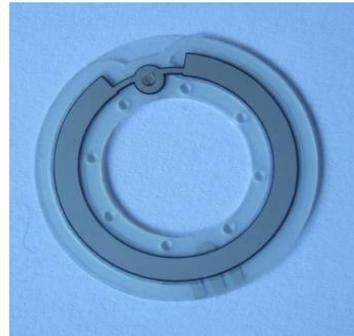
Kreispotentiometer in Robotik-Anwendung mit Positionslöchern
