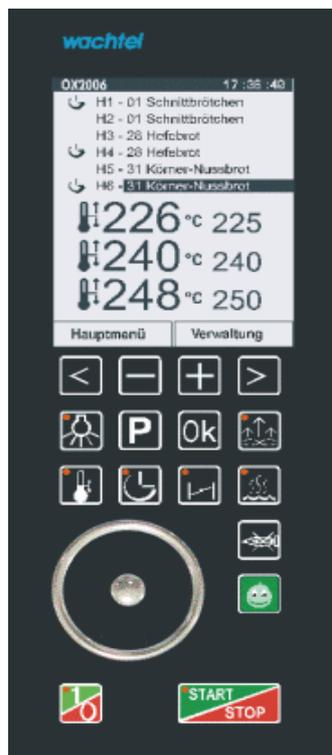
In diesem Bedienpanel waren 12 Tasten als Matrix und ein versengter Drehknopf vorgesehen Ein wichtiger Parameter ist Dichtigkeit.
