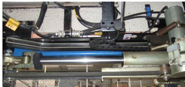
700mm langes Folienpotentiometer wurde durch ein Sensofoil Hybrid ersetzt. Die Lebensdauer wurde mehr als verdoppelt. Anwendung in dem Türsystem einer Strassenbahn
