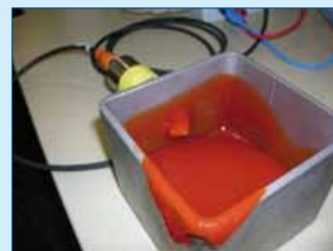
Figuur 1. Een dikke laag ketchup die op de sensor achter gebleven is, leverde voorheen niet de gewenste detectie van het vloeistofniveau op.
