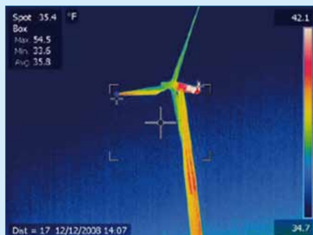
Figuur 4. Bij de hedendaagse windmolens kan met warmtebeelden zeer gemakkelijk geïnspecteerd worden of alles nog wel werkt zoals het behoort.
